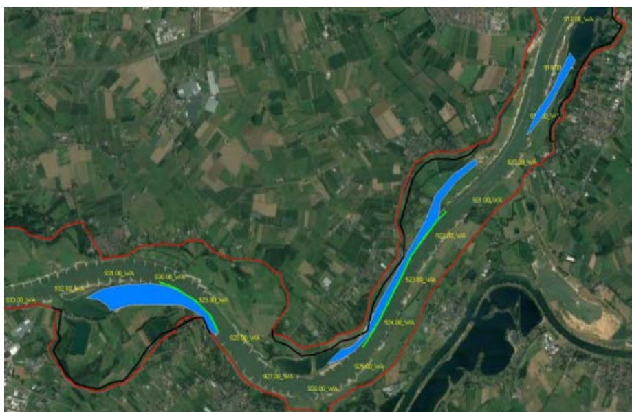
Figuur: De langgerekte geulen in de uiterwaarden liggen parallel aan het zomerbed en worden afgescheiden door grond of langsdammen. Er zijn drie geulen aangemerkt. Note: De tweede geul is te lang ingetekend (alleen het bovenste gedeelte kan gerealiseerd worden), doordat je ook een dikke dijk moet hanteren, blijft er geen ruimte over voor een geul.
